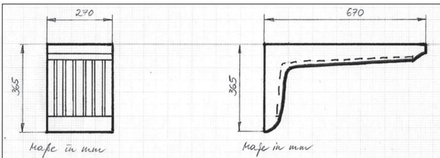
Fotos: Ansicht von vorn und Ansicht von links (Konsole als Rohteil – bisher ohne Beschichtung)
